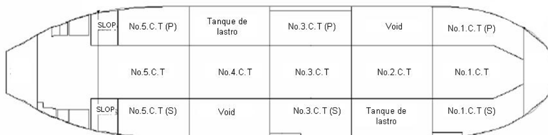
Figura II.2.4-10 - Croqui ilustrativo do posicionamento dos tanques de armazenamento de óleo na unidade FPSO Cidade de Niterói.
